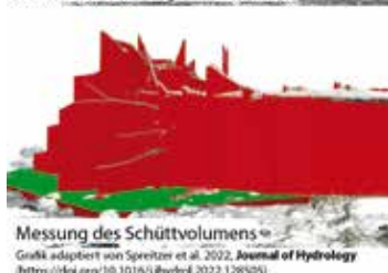
Bild 2: 3D-Vermessung einer Schwemmholtzverklausung am Vorderrhein.
